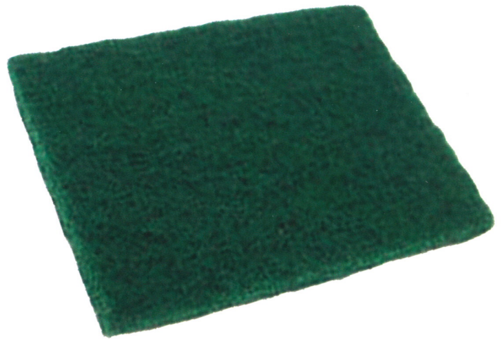
Scotch-Brite utilisé dans la norme ISO 11998
