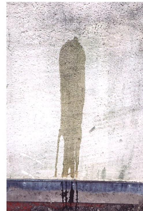
Test à l'eau (déterminer l'absorption du support)
